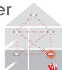
Die Funkmodule arbeiten als Repeater bzw. Verstärker – für hohe Reichweite und stabiles Netz.
